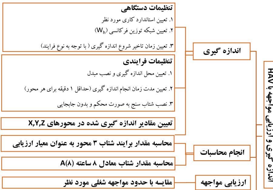
شکل ۱ - نمودار اندازه‌گیری و ارزیابی مواجهه با ارتعاش دست بازو
